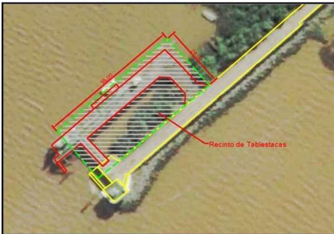
Figura 4: Recinto de Tablestacas. Planta
